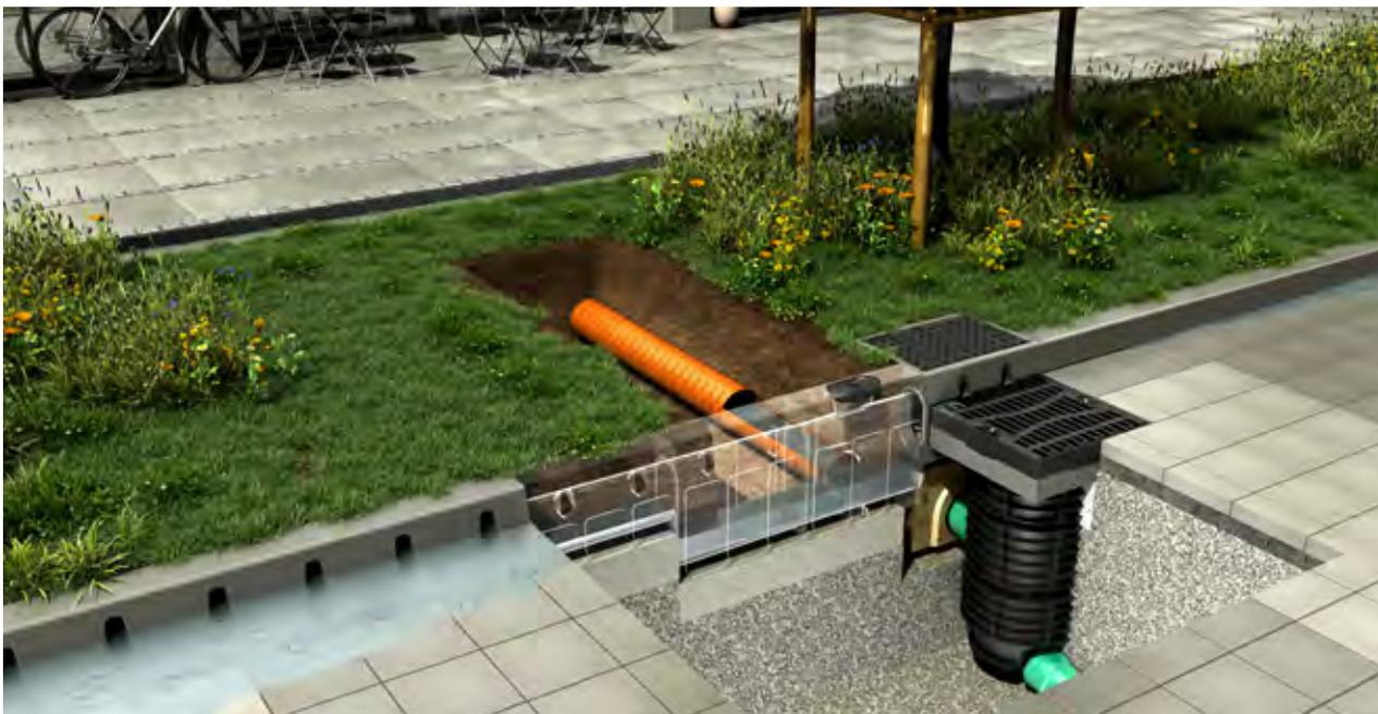
ACO Drain®Box ist der neue Lösungsbaustein für gefährliche Überflutungs-Hotspots. Das Besondere an der ACO Drain®Box ist die Kombination von Linien- und Punktentwässerung. Vor dem Punktablauf nehmen die seitlichen Öffnungen der Hohlbordrinne entlang des Bordes einen Teil des anströmenden Wassers auf. Bereits mit ein paar
