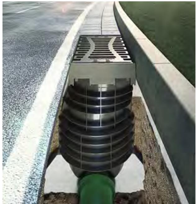
Für Fahrgassen von Parkflächen, Pkw- und Lkw-Umfahrten ist eine punktuelle Entwässerung vorteilhaft. Der ACO Straßenablauf Combipoint PP bietet zusammen mit den Aufsätzen im Multitop-Design eine ideale Entwässerung für Stellplatz- und Fahrbereiche. Die leichten Abläufe bestehen aus Kunststoff und sind drehbar, teleskopierbar, kürzbar sowie in der Neigung passend auszurichten.
