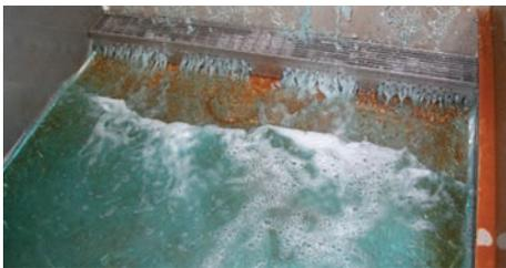
Prüfung des Rinnenkörpers mit Maschenrost 30 x 10 mm, freier Ablauf wie geständerter Belag
