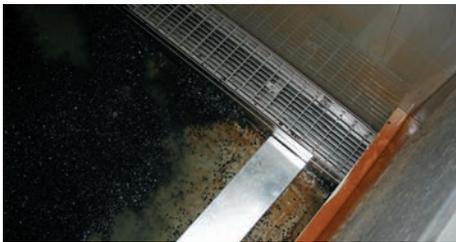
Prüfungsaufbau mit seitlich angesetztem Stichkanal (ohne Ausschnitt im Rinnenkörper)
