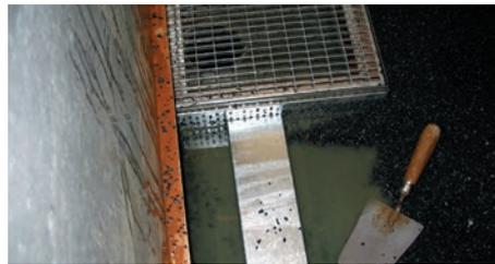
Prüfungsaufbau mit seitlich angesetztem Stichkanal (ohne Ausschnitt im Aufsatz für Dachabläufe)
