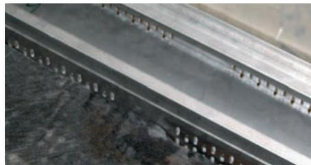
Prüfungsaufbau mit Dränagematte und Splittbett vor dem Rinnenkörper
