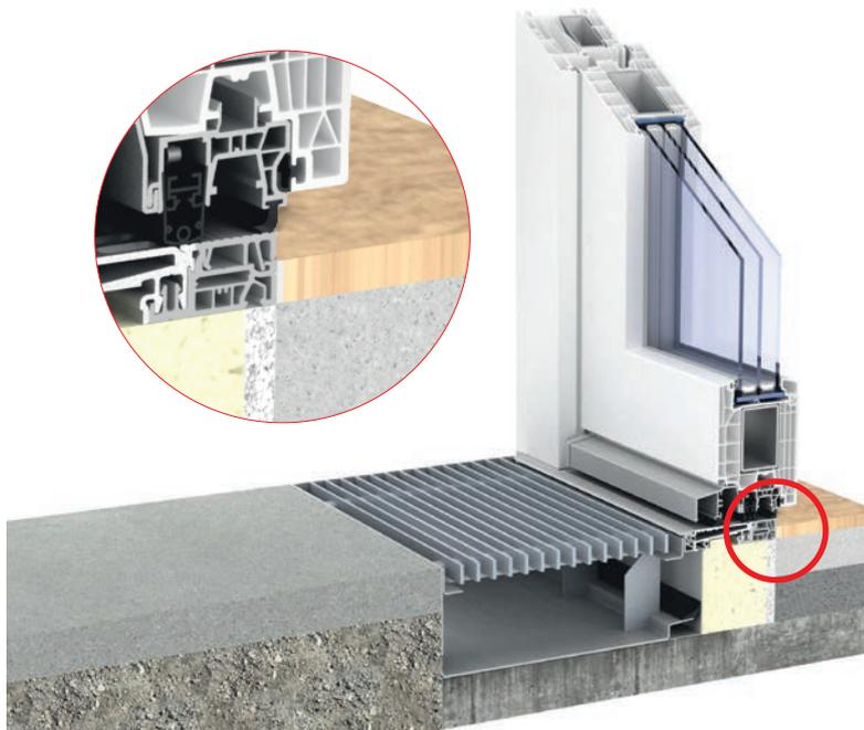
Durch eine clevere Adaption und unter Verwendung der bereits bewährten 20-mm-Schwelle, verwandeln sich alle unsere Haustür- und Terrassensysteme in den Bautiefen 76 und 88 zu barrierefreien Schwellenlösungen. Bei den Flügelprofilen werden die inneren Flügelüberschläge beschnitten und mit einer speziellen Anschlagdichtungsleiste versehen.
