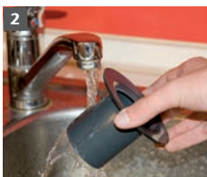
Rengör luktfällan under vatten.
