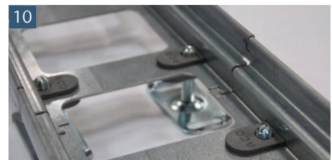
Wenn die Schraube mit dem Kunststoffteil oben abschließt, kann der Stellfuß nicht mehr herausfallen
