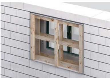
4. Aussteifungen erst nach Erhärten des Mörtels entfernen.
