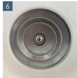
6 Die Schraubendichtung muss vollflächig und zentriert unter der Schraube liegen. Bitte darauf achten, dass die Dichtung sauber unter der Schraube liegt. Notfalls Schraube nochmals leicht lösen und erneut anziehen.
