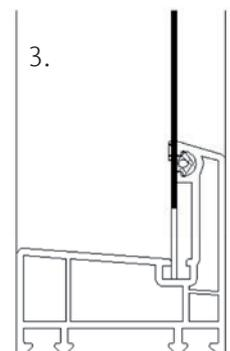
Dann die Scheren aus dem Rahmen ausbauen, das Schutzgitter, mit den Aussparungen für Profilträger unten, in den Rahmen stellen (Zeichnung 2 und 3), Scheren wieder in den Rahmen eindrücken, Flügel wieder einsetzen, fertig!
